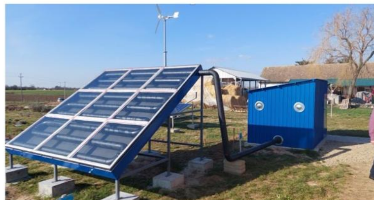
Слика 1. Изглед соларне сушаре с колектором енергије, топлотним складиштем и комором за сушење сировина
