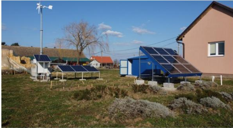
Слика 1. Изглед соларне сушаре с колектором енергије, топлотним складиштем и комором за сушење сировина
